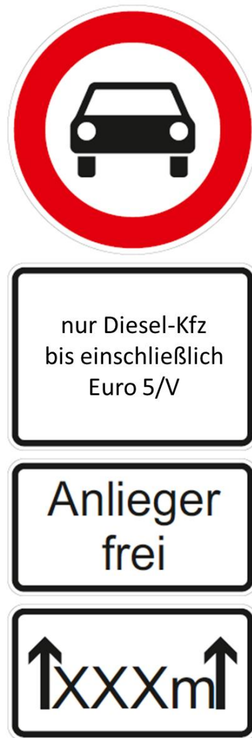
Abbildung 13: Verbot für Kraftwagen (Zeichen 251 StVO), Zusatzzeichen „nur Diesel-Kfz bis einschließlich Euro 5/V“, Anlieger frei (Zusatzzeichen 1020-30) und ein Zusatzzeichen zur Visualisierung der Länge der Verbotsstrecke
